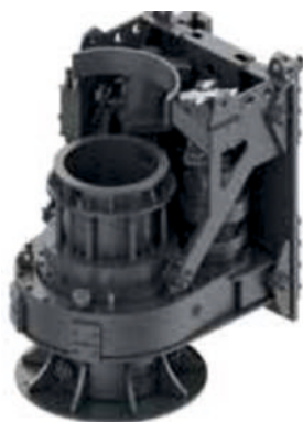
ВРАЩАТЕЛЬ: СТАНДАРТНАЯ КОМПЛЕКТАЦИЯ С ВЫСОКОСКОРОСТНЫМ СБРОСОМ ГРУНТА ЗАЩИТА АККУМУЛЯТОРА ОТ УДАРОЧНОГО УПЛОТНЕНИЯ, УВЕЛИЧЕННЫЙ СРОК СЛУЖБЫ ДВИГАТЕЛЯ ВРАЩАТЕЛЯ
